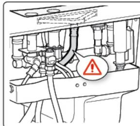
Instalar el dispositivo de protección contra reflujo, dependiendo de la normativa local vigente. Para cumplir con la norma EN-1717, instalar la referencia Roca: A248312000
